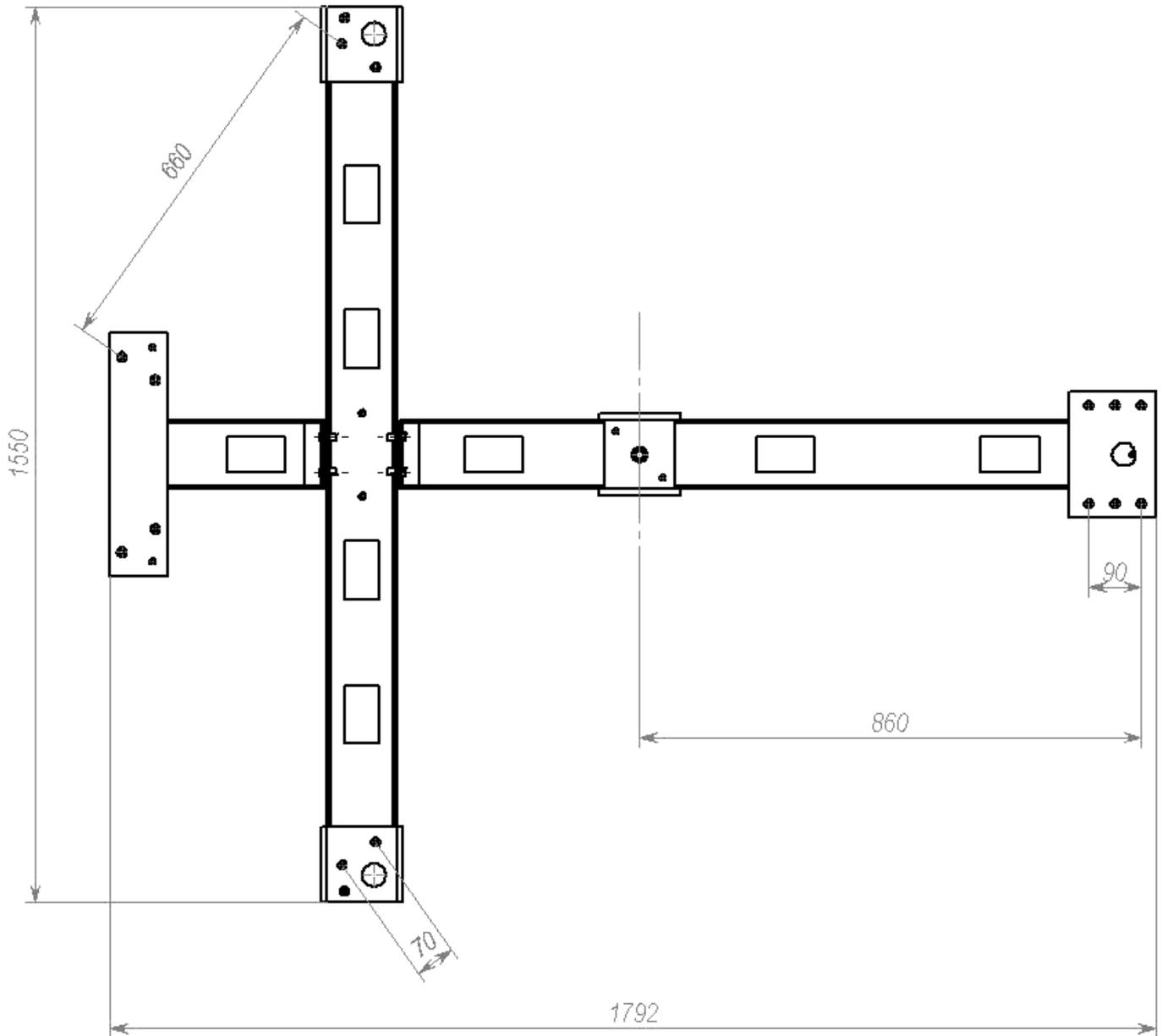
Рисунок 1 – Габаритные и установочные размеры рамы
